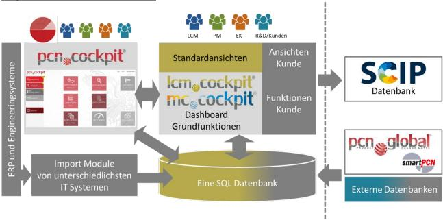
Alle Systeme pcn.cockpit , lcm.cockpit und mc.cockpit nutzen dieselbe Datenbank, die bei Ihnen vor Ort installiert ist und ein Höchstmaß an Vertraulichkeit und volle Kontrolle über Ihre Daten bietet.
